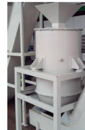
Centrífuga Contínua para cavacos uniformizados ▲
